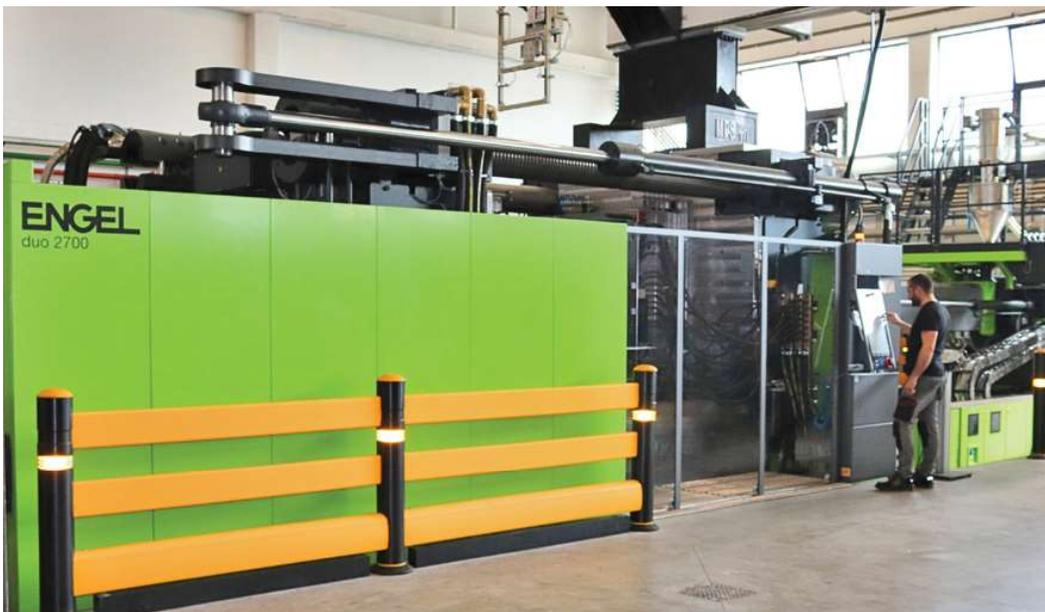
**La nuova Engel duo 2700 è dotata di un gruppo di plastificazione che assicura una miscelazione uniforme e riduce sensibilmente la variabilità del materiale da post-consumo, minimizzando gli scarti**
